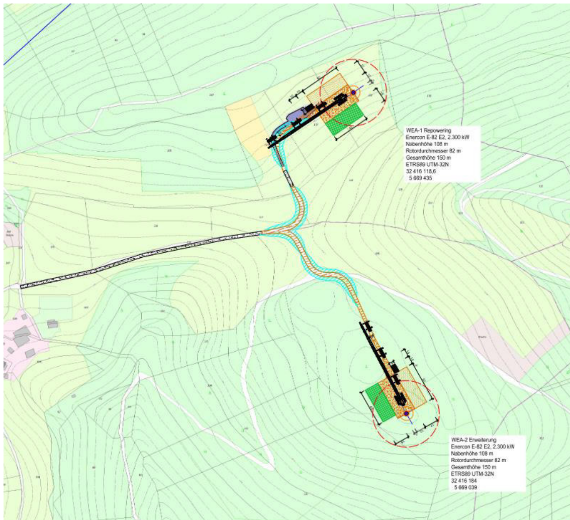
Abb. 13: Zuwegeplanung sowie Kranstell- und Einrichtungsflächen mit WEA-Standorten, Stand: 15.05.2023 (© Mark-E) (© Karte: Land NRW (2023) Datenlizenz Deutschland - Zero - Version 2.0)
